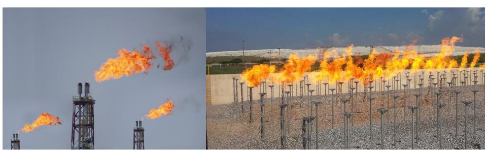
L'utilizzo dei sistemi torcia genera sia una sorgente di emissioni in atmosfera che la combustione di prodotti potenzialmente di valore. Pertanto, al fine di preservare l'efficienza energetica, il loro utilizzo deve essere limitato il più possibile e ridotto alle situazioni in cui esso sia indispensabile.
